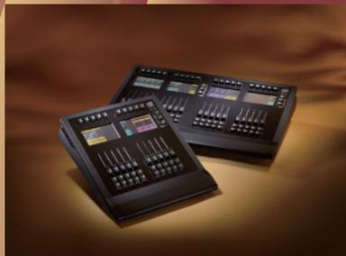
Eos Motorized Fader Wings は、複雑で多彩なシーンのプログラミングをスムーズにする、モーターフェーダー搭載の拡張デバイスです。10 本または 20 本の 60mm モーターフェーダーとフルカラー LCD ディスプレイを搭載し、ページを切り替えると自動でフェーダーが位置を調整。これにより、大規模なシステムでも迅速かつ正確な操作を実現します。
