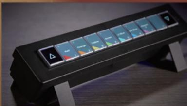
TK 10 は、Apex シリーズのパワフルなターゲットキー機能を、持ち運び可能なコンパクトサイズで実現したボタンアクセサリです。10 個のカスタマイズ可能なディスプレイ付きボタンを搭載し、プログラミング中でも素早く、直感的に操作が可能。ラベルや画像、ナビゲーション要素をボタンに設定できるので、複雑なシーンもスムーズに進行できます。
